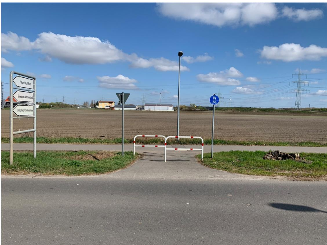
Die Umlaufsperrn auf dem **Geh- und Radweg in der Verlängerung „Im Feldchen“ bis „Am Schmiedtor“** sollten komplett entfernt und durch einen mittig im Weg platzierten, rot-weiß reflektierend markierten Sperrpfosten ersetzt werden. Gegebenenfalls ist auf der Grünfläche (im oberen Foto rechts) dann eine Umlagerung des Findlings weiter an den Weg bzw. ein weiterer Findling nötig um die Durchfahrt für PKW effektiv zu verhindern.
