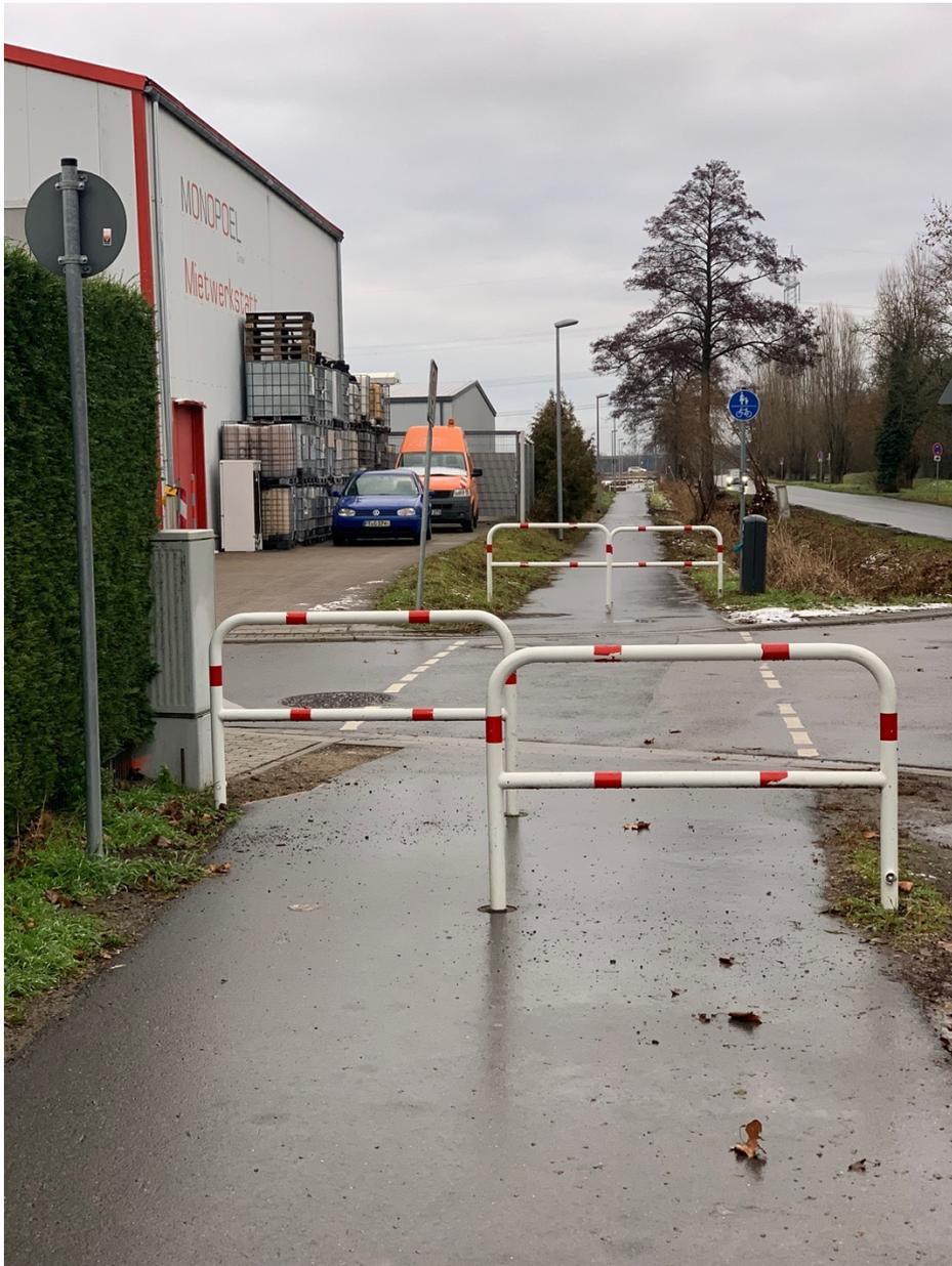
Am **Übergang von dem Geh- und Radweg entlang der Straße „Eppsteiner Weg“ zur Straße „Am Holzacker“** sollten die Umlaufsperrn entfallen, da sie sich in einer Steigung zur Straße hin befinden, durch welche der Radverkehr ohnehin gebremst wird. Zur Vermeidung missbräuchlicher Nutzung des Radweges könnte ein einzelner Sperrpfosten mittig installiert werden, den Bedarf sehen wir aber nicht gegeben.
